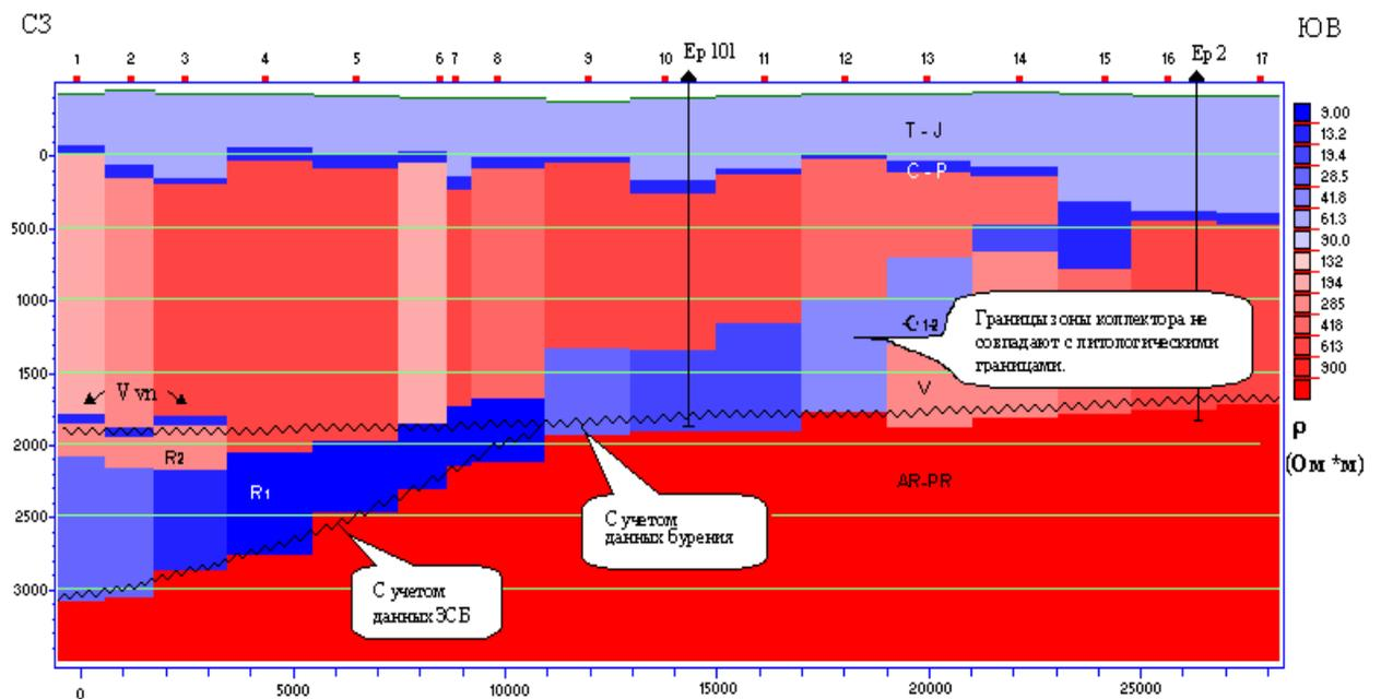
Рис. 35. Геоэлектрический разрез ( результаты послойной интерпретации ) по профилю 310 Ереминской площади, с учетом данных глубокого бурения.
