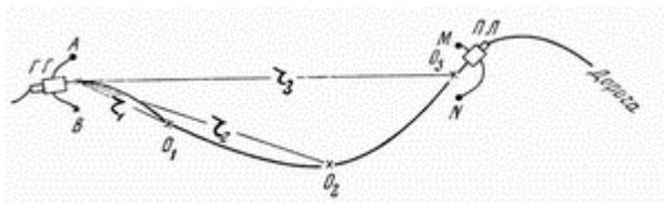
Рис. 30. Схема проведения дипольного азимутального зондирования: ГГ - генераторная группа, ПЛ - полевая лаборатория
