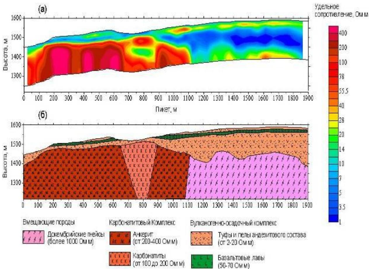
Рис. 26 (а) - геоэлектрический разрез по удельному электрическому сопротивлению;
