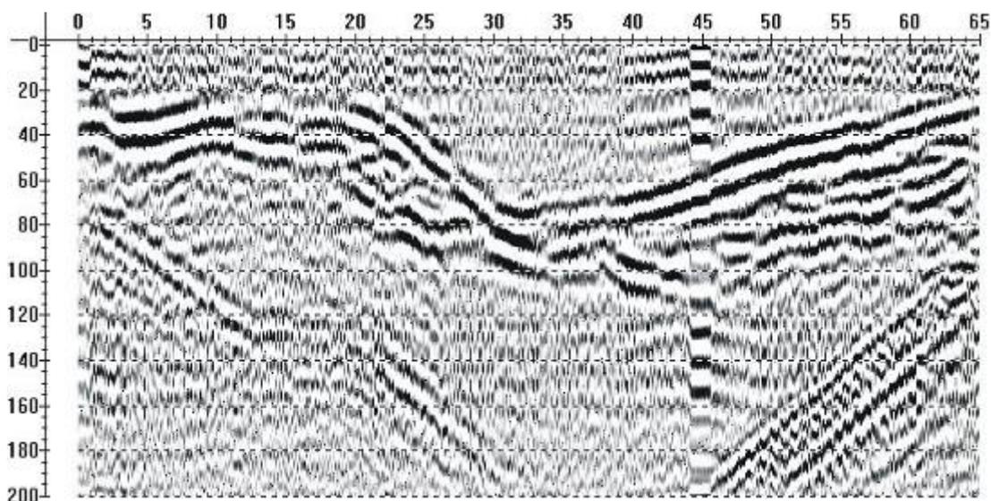
Рис. 37. Результаты георадиолокационных работ по профилю поперек р. Угры (район д. Александровка, июнь 1998). Георадар "Зонд-10", частота 150 МГц.
