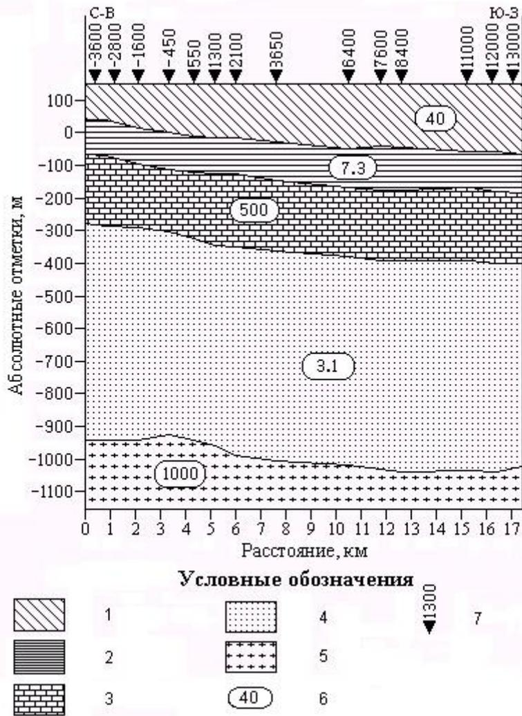
Рис. 38. Геоэлектрический разрез по профилю
