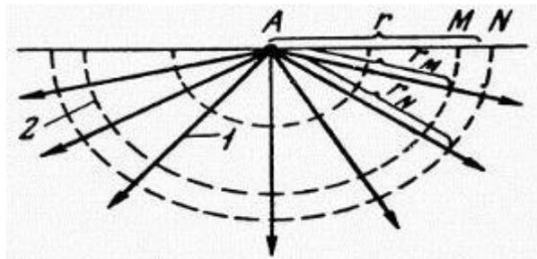
Рис. 16. Поле точечного источника постоянного тока А над однородным изотропным полупространством: 1 - токовые линии, 2 - эквипотенциальные линии.
