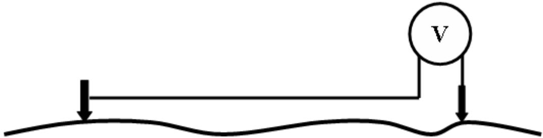
Рис. 2. Электроразведочная установка для измерения естественного электрического поля.
