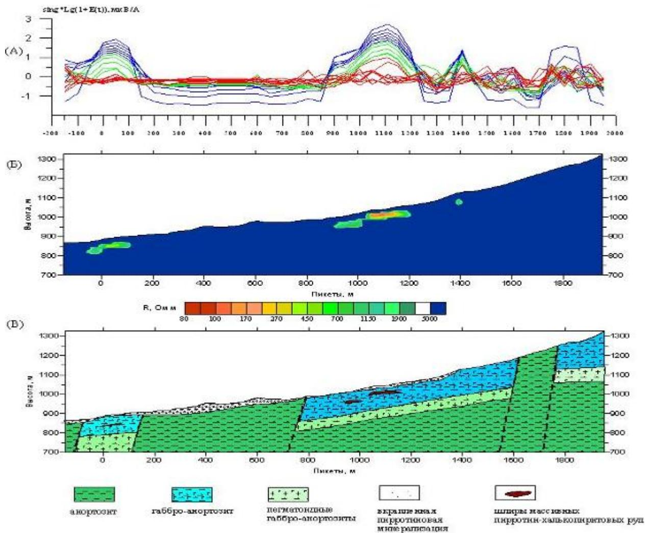
Рис. 25. Результат исследований методом переходных процессов по профилю.
