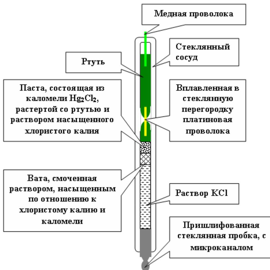
Рис. 13. Устройство каломельного электрода.
