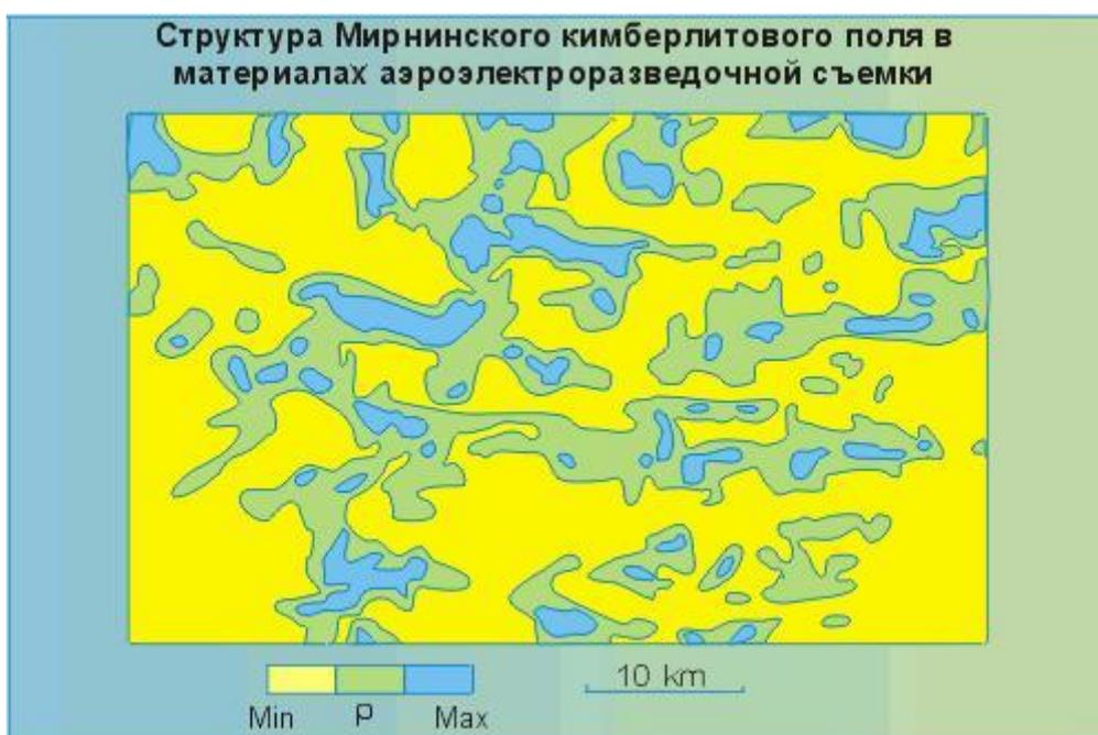
Рис. 27. Данные аэроэлектроразведки.
