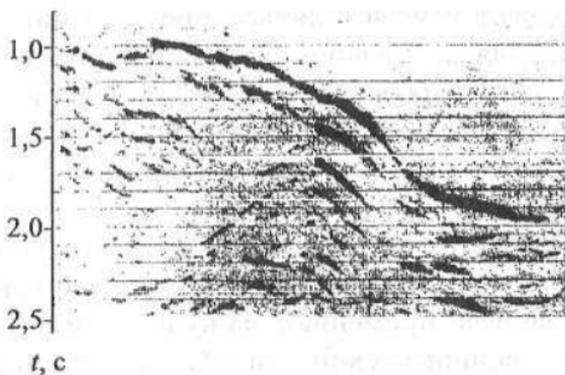
Рис. 7.17. Временной разрез по сопряженным точкам преломленных волн после миграции.
