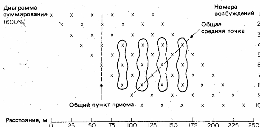
Рис. 3.66. Диаграмма суммирования для поверхности наблюдений. Выделены трассы, подлежащие смещению при имитации групп источников с длиной базы 50 м для случая шестиканальной приемной косы, интервала между приемными группами 25 м и между пунктами возбуждения 12,5 м.
