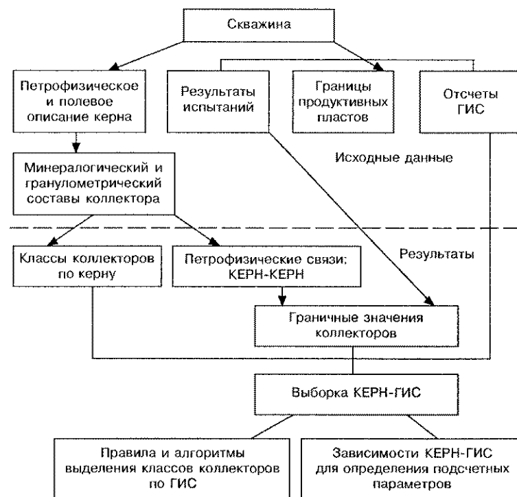
Рис. 8.3. Технологическая схема петрофизического обоснования для расчета подсчетных параметров в системе ГЕММА
