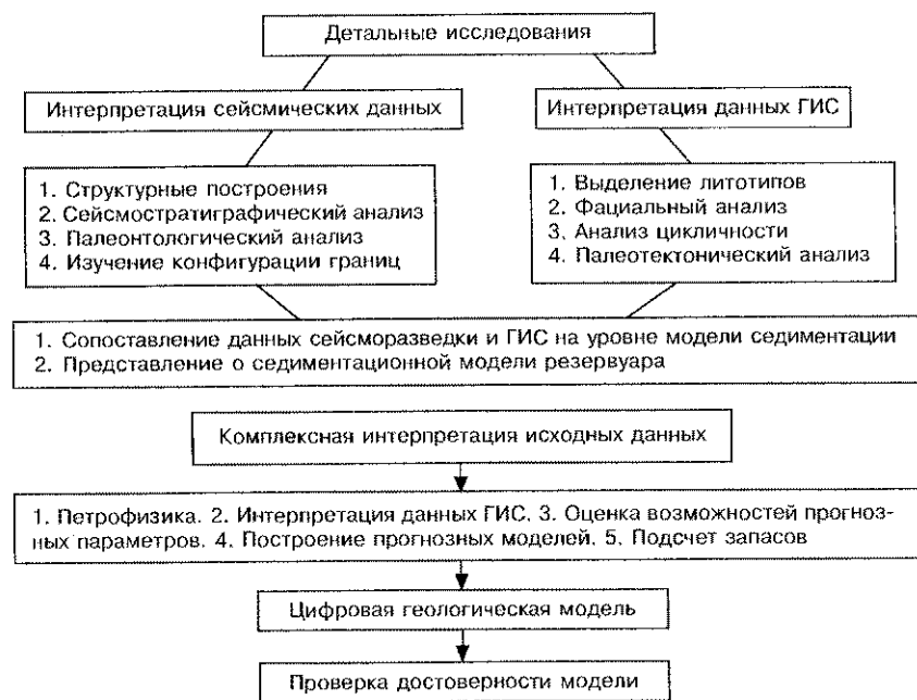
Рис. 8.2. Технологическая схема построения модели резервуара (по С. Б. Денисову)
